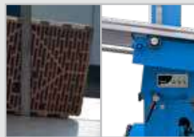
Taglio inclinato su mattoni con cavità vuote
