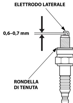
6. Una volta alloggiata la candela, serrare con una chiave per candele da 16 mm per comprimere la rondella di tenuta.
