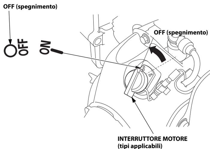
3. Se il serbatoio del carburante è dotato di una valvola o del tappo del bocchettone di rifornimento carburante con pomello, ruotarli nella posizione di CHIUSURA o OFF.
