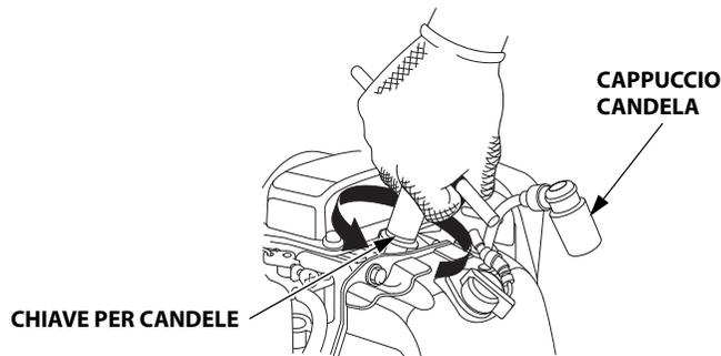
3. Controllare la candela. Sostituirla se è danneggiata o molto imbrattata, se la rondella di tenuta è in cattive condizioni o se l'elettrodo è usurato.
