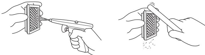
**Cartuccia in schiuma:** Pulire in acqua saponata tiepida, risciacquare e lasciare asciugare perfettamente. Oppure, pulire con un solvente non infiammabile e lasciare asciugare. Non versare olio sulla cartuccia in schiuma del filtro aria.
