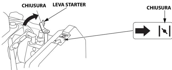
Per riavviare il motore quando è ancora caldo, lasciare la leva dello starter in posizione di APERTURA.
